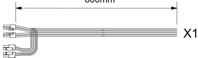
CPU EPS CABLE 4+4PIN 600mm
