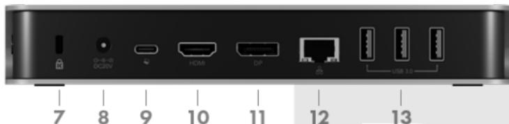
7. Kensington-Sicherheits-Slot zur Sicherung gegen Diebstahl
