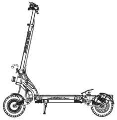
3..Tournez le bouton pour verrouiller le clip de pliage.
