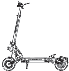
2. Placez le tube du guidon dans le support.
