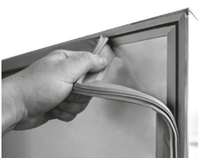
Les joints de porte doivent être nettoyés régulièrement. En cas de dommage, le remplacement des joints est nécessaire pour le bon fonctionnement de l'appareil. Pour retirer le joint de l'emboîtement, détachez le coin et tirez lentement dessus. Vous pouvez placer le nouveau en le pressant dans les emboîtures.
