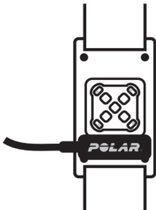
Der Polar Loop schaltet sich ein, wenn du ihn zum Aufladen anschließt. Während des Ladevorgangs zeigen die LEDs den Fortschritt an: Im Uhrzeigersinn rot rotierende LEDs zeigen an, dass der Ladevorgang läuft, und wenn der Akku voll geladen ist, leuchten die roten LEDs dauerhaft.
