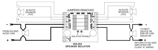
THE (+) LED WILL BLINK FOR AN OPEN ON THE POSITIVE SIDE OF THE IN-SUITE SPEAKER, SIMILARLY, THE (-) LED BLINKS FOR AN OPEN CIRCUIT ON THE NEGÀTIVE SIDE OF THE IN-SUITE SPEAKER.
