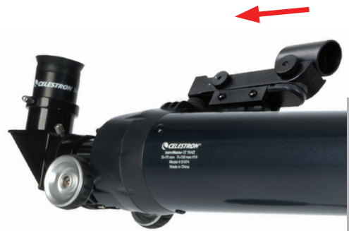
Sucherfernrohr in einem Refraktorteleskop
