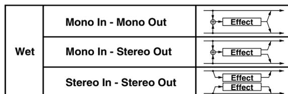
Nel diagramma a blocchi di ogni effetto nelle pagine che seguono, la configurazione input/output è elencata nella parte superiore sinistra nel diagramma.
