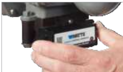
3. Compruebe que el módulo esté completamente asentado para sellar la junta tórica y hacer contacto eléctrico.
