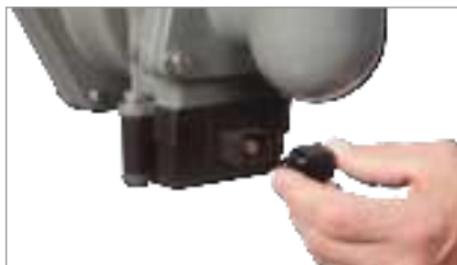
1. Retirez le couvercle antipoussière du capteur.
