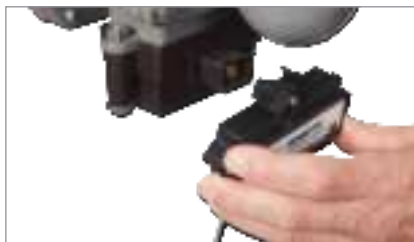
2. Enfoncez le module d'activation sur le capteur.
