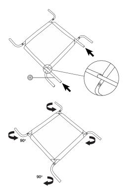
Insérez les deux barres métalliques dans le tapis à travers les trous.
