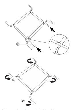
Inserte las dos barras metálicas en la base, a través de los orificios.
