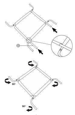
Schieben Sie die zwei Metallrohre durch die Öffnungen in die Matte.
