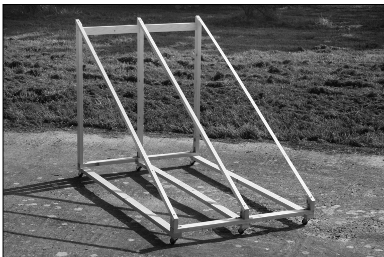
Figure 4-59 - Avec le vissage des trois cornières inclinées en aluminium, le châssis du suiveur commence à prendre forme.
