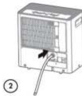
Conectar la manguera de desagüe.
