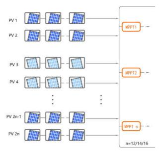
figure 5-6 PV Input Configuratioon
