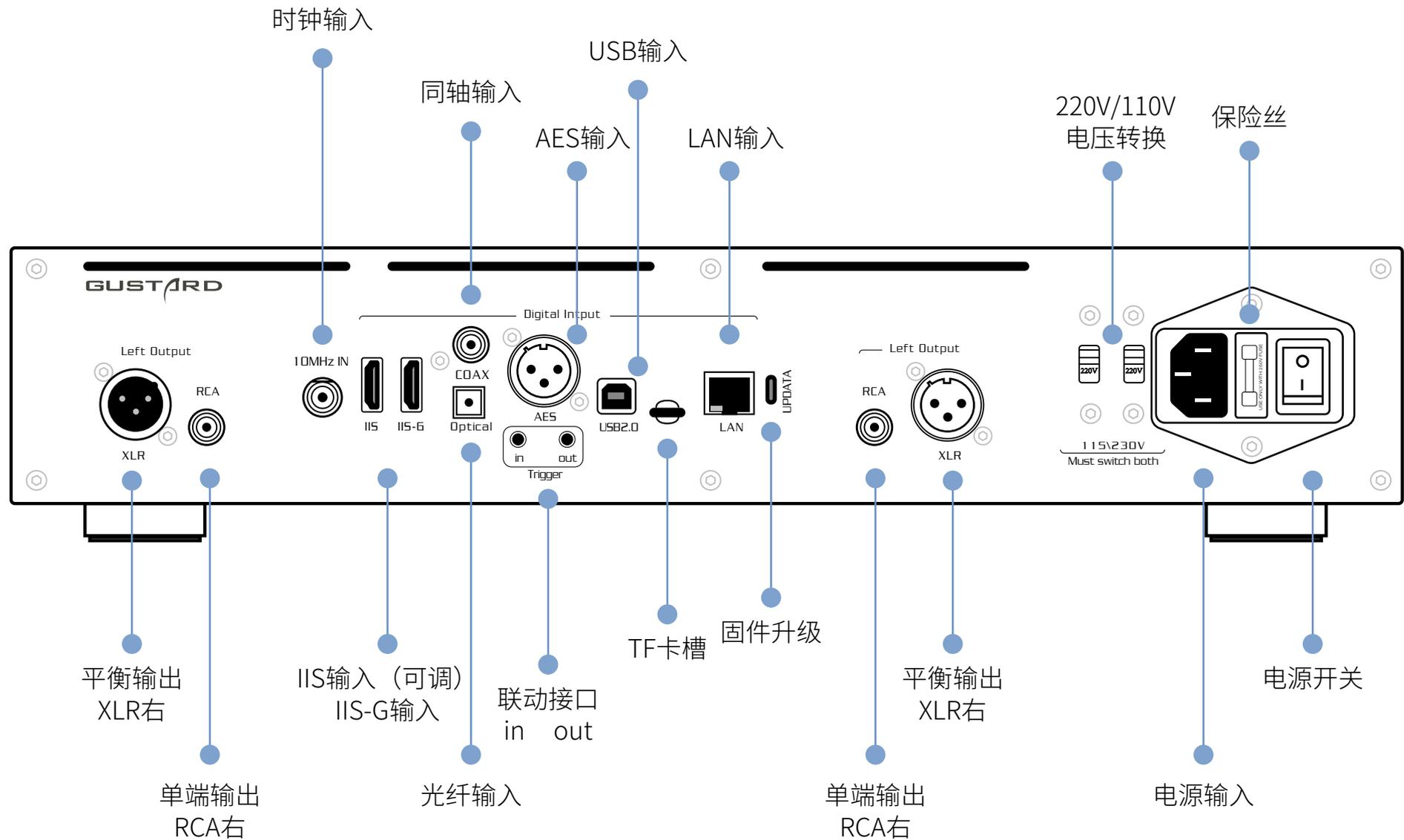
\*\* 在操作 220V/110V 电压切换开关时，请务必将两个开关同时设置成相同的电压，否则上电后会致机内变压器损坏
