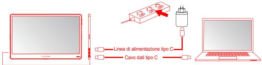
1. Collegare un'estremità del cavo dati tipo C a una delle due porte tipo C della macchina e l'altra estremità alla porta di segnale tipo C del laptop.
