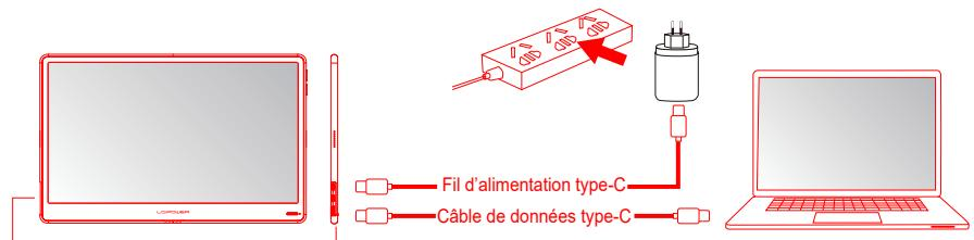
1. Branchez l'une des extrémités du câble de données type-C à l'un des deux ports types-C de l'appareil, puis branchez l'autre extrémité dans le port de signal type-C de l'ordinateur portable.
