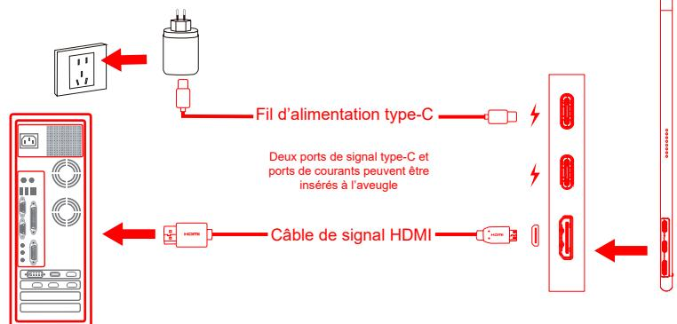
1. Branchez le câble HDMI au port mini HDMI du produit et au port HDMI du PC.
