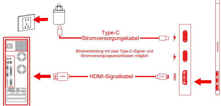
1. Verbinden Sie das HDMI-Kabel mit dem Mini-HDMI-Anschluss des Produkts und dem HDMI-Anschluss des PCs.
