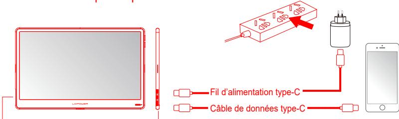
1. Branchez l'une des extrémités du câble de données type-C à l'un des ports types-C de l'appareil, puis reliez l'autre extrémité au téléphone portable.
