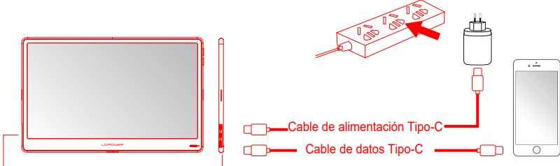
1. Conecte el cable de datos Tipo-C a uno de los puertos Tipo-C de la máquina y conecte el otro extremo al teléfono móvil.
