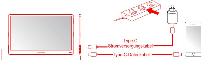
1. Verbinden Sie das Type-C-Datenkabel mit einem der Type-C-Anschlüsse des Produkts und das andere Ende mit dem Mobiltelefon.
