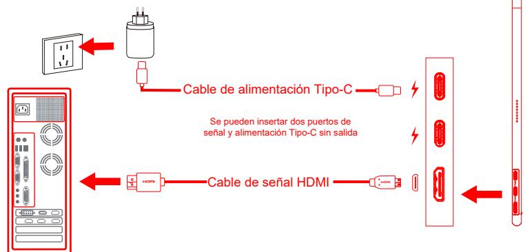
1. Conecte el cable HDMI al puerto Mini-HDMI del producto y al puerto HDMI del equipo de sobremesa.
