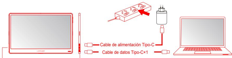
1. Conecte un extremo del cable de datos Tipo-C a uno de los dos puertos Tipo-C del monitor de la máquina y el otro extremo al puerto de señal Tipo-C del equipo portátil.
