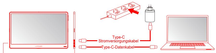
1. Verbinden Sie ein Ende des Type-C-Datenkabels mit einem der beiden Type-C-Anschlüsse des Produkts und das andere Ende mit dem Type-C-Signalanschluss des Laptops.
