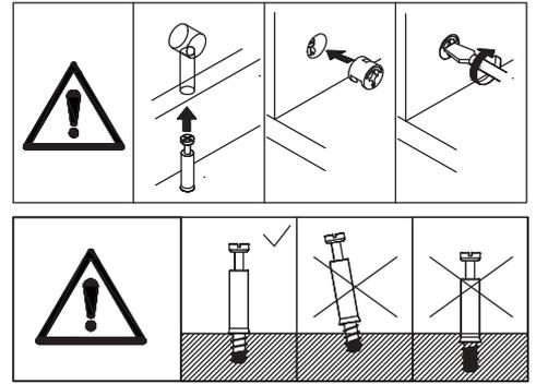
Insérer d'abord la vis quickfit (A) dans la planche 10, puis la fixer à la planche 2 à l'aide de la cheville en bois (D).
