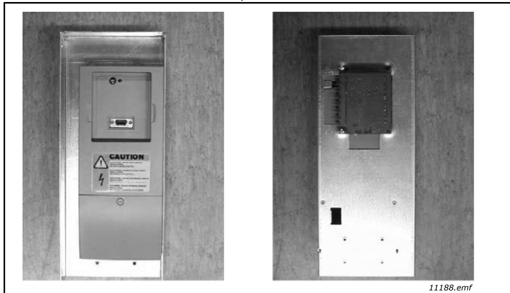
Figura 30. Unidad de control instalada en la caja de montaje; Izquierda: parte frontal; Derecha: parte posterior
