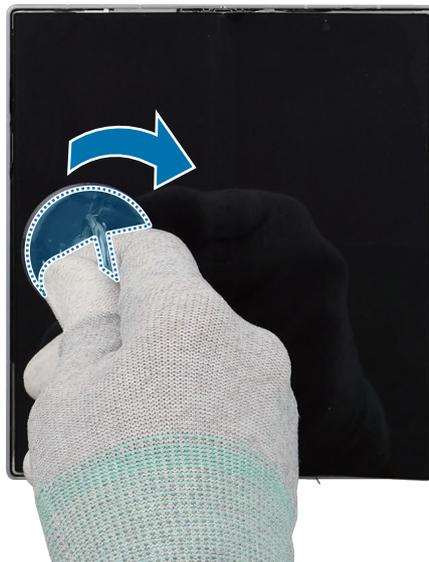
16 Insérez délicatement le médiateur dans l'interstice créé et soulevez légèrement l'écran. Faites glisser le médiateur le long du bord pour découper l'adhésif entre l'écran et le châssis métallique, puis dégagez lentement l'écran tout en le soulevant entièrement avec une force mesurée et régulière. Lorsque vous séparez la partie droite de l'écran, soulevez lentement et délicatement l'écran avec les mains pour éviter d'endommager les composants situés à l'intérieur.
