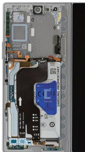
2 Repérez et retirez les 4 vis à l'aide d'un tournevis cruciforme.
