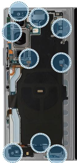
2 À l'aide de la pincette plastique, séparez avec précaution le connecteur MFC et les adhésifs. Puis, à l'aide de la pincette plastique, soulevez la partie supérieure gauche de l'antenne inférieure, puis retirez-la avec précaution de l'appareil avec le module de chargement sans fil.
