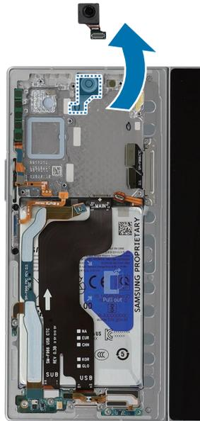
1 Débranchez les connecteurs flexibles sur la partie inférieure.
