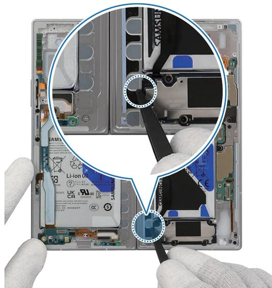
8 Placez l'appareil précisément sur le gabarit, qui sert à appliquer l'adhésif FULLER EH9377. Appliquez l'adhésif FULLER EH9377 en suivant la ligne de guidage de l'adhésif du haut vers le bas.
