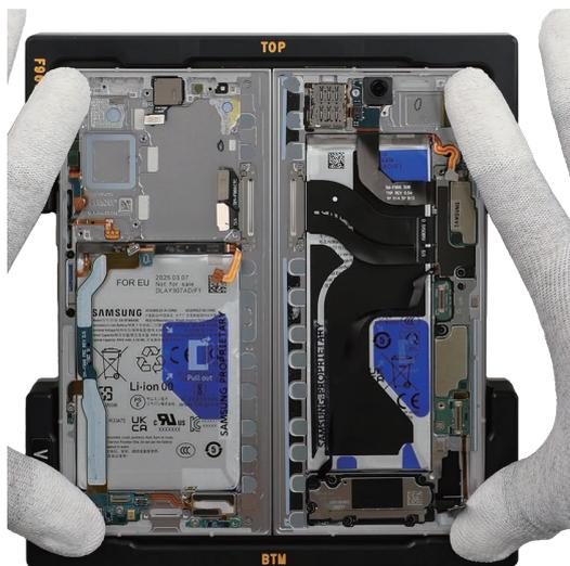
19 Aligned l'appareil sur le plateau de presse inférieur de l'écran principal. Placez l'écran orienté vers le haut sur le plateau de l'écran principal.
