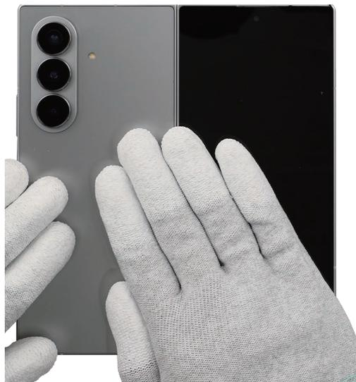
6 Si vous pouvez louer un kit d'outils pour l'autoréparation, ou si le rouleau ou le tampon presseur est fourni avec les pièces de rechange que vous avez commandées, vérifiez les étapes de la procédure [Application d'une pression sur le cache arrière](#). Vous pouvez appliquer une pression supplémentaire sur le cache arrière entièrement remonté à l'aide de l'outil approprié.
