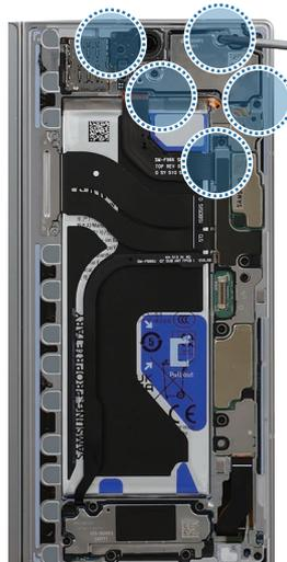
2 À l'aide de la pincette plastique, soulevez l'encoche de séparation sur le coin supérieur droit au niveau de la flèche du module de haut-parleur supérieur, puis retirez-le avec précaution de l'appareil.
