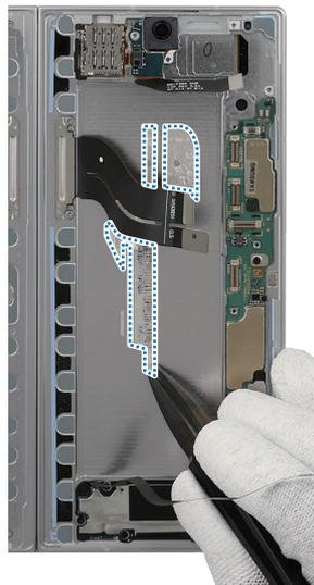
7 Fixez le ruban mousse pour batterie secondaire sur la face avant de la batterie et retirez le film détachable sur la face avant de la nouvelle batterie à l'aide de la pincette plastique ou de vos doigts.
