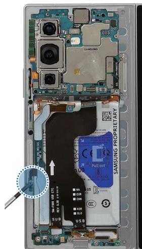
14 Avec les doigts, branchez les 3 connecteurs (le connecteur de la touche d'empreintes, le connecteur FRC FPCB, le connecteur du port de chargement). Ensuite, branchez le connecteur de la batterie.
