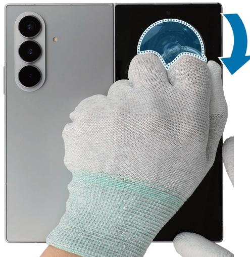
3 Tout en tirant la ventouse vers le haut fortement et régulièrement pour créer un espace entre l'écran extérieur et le module d'écran, insérez l'outil de démontage métallique dans l'espace au niveau du bord supérieur. Ensuite, faites glisser l'outil de démontage métallique d'avant en arrière entre l'interstice pour retirer l'adhésif du bord supérieur.
