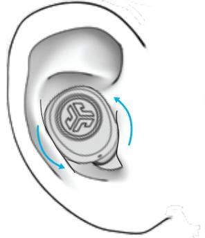
Placez l'écouteur dans votre conduit auditif et faites-le pivoter légèrement pour l'ajuster au mieux.
