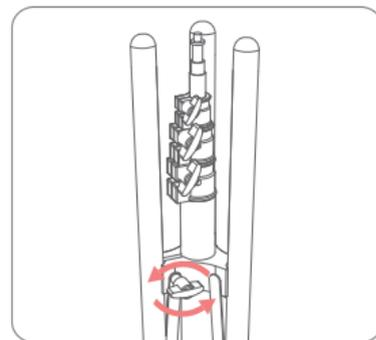
1. Desserrez le « bouton de verrouillage » en le tournant dans le sens antihoraire, écartez les pieds vers l'extérieur afin d'ajuster leur angle.
