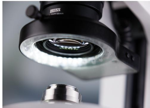
无影环形光拥有四种不同的分段模式：整圆、半圆、四分之一圆和两个相对的四分之一圆。设置分段照明，然后以 90° 步进手动旋转照明方向，在不移动样品的情况下快速检测划痕、缺陷或残留物。或者使用自动旋转模式，通过仅改变阴影的方式来获得物体表面的立体效果。
