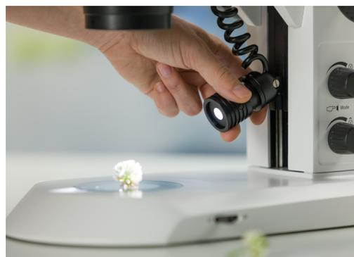
调整照明高度，放大产生不同阴影，以加强立体感。在最低位置处，它可以提供反射照明，增强平面上的精细结构。
