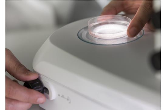
可倾斜且可移动的反射镜能够提供明场、单侧暗场和倾斜光照明，还可选配偏光观察方式。旋转至磨砂和平面镜侧，可在清晰和弥散明场之间进行切换。
