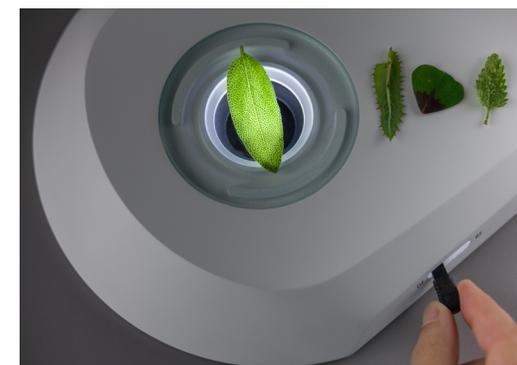
使用平透射光照明器，能够在明场和暗场下对比彩色透明样品。加入起偏器 / 检偏器设备观察双折射晶体或玻璃、塑料内的张力。
