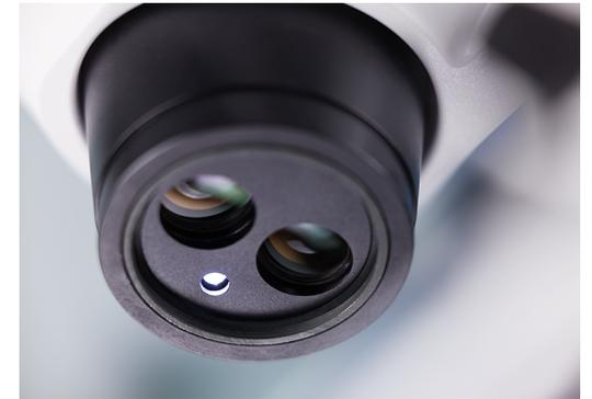
Stemi 355 配有集成式近垂直 LED 点光源，通过前端镜，甚至能够照亮孔洞和凹痕。
