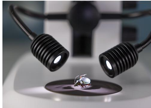
在反射光下制备样品时，标配的鹅颈式导光管的双点光源效果出众。其能产生半阴影效果，从而在无暗影重叠的情况下获得出色的三维图像。在解剖样品时，即使操作显微镜的手挡住了其中一个点光源，仍能获得持续的照明。
