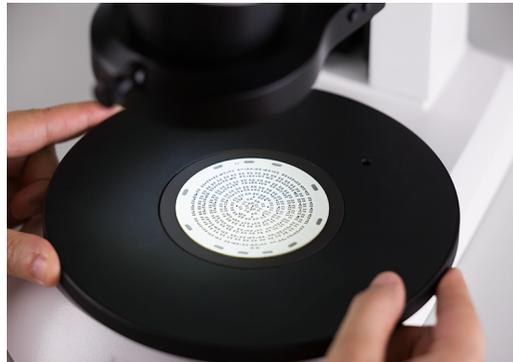
使用万向式、滑动式或旋转偏光载物台精准定位样品。
