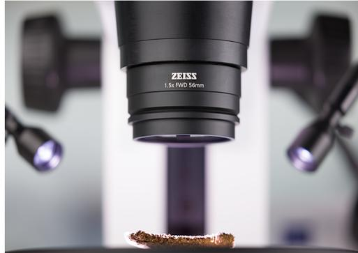
多种可更换的前端镜和目镜供您选择，放大倍率介于 3.6x 和 200x 之间，Stemi 355 的分辨率可提高一倍，或使自由工作距离和视野最大化。
