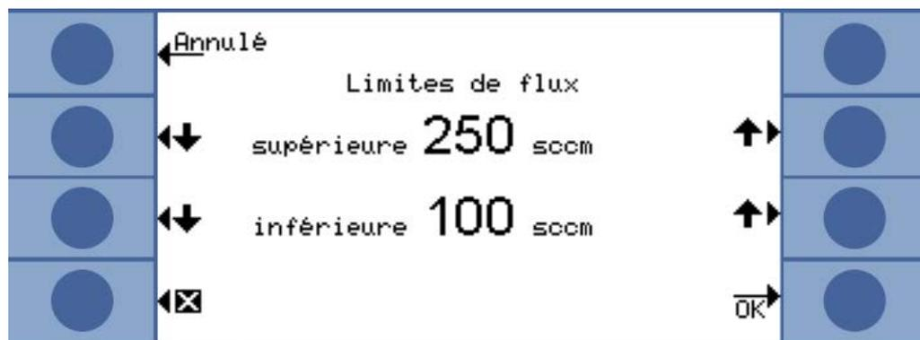
Fig. 16: Réglage des limites du flux
