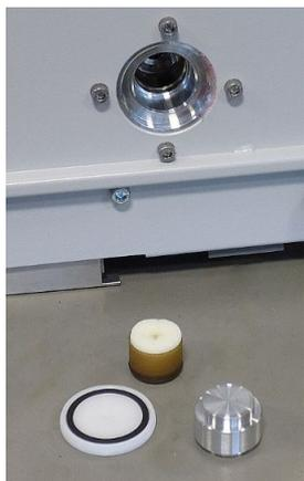
Fig. 49: Réservoir de lubrifiant ouvert 4 cm
