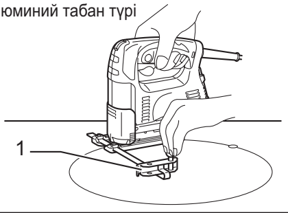
► Сурет25: 1. Бағыттаушы тақтайша (бағыттауыш сызғыш)
