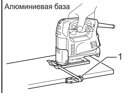
► Рис.19: 1. Направляющая планка (направляющая линейка)
