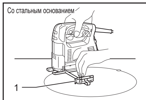
► Рис.24: 1. Направляющая планка (направляющая линейка)
