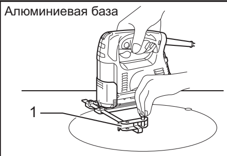
► Рис.25: 1. Направляющая планка (направляющая линейка)
