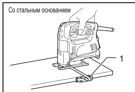
► Рис.18: 1. Направляющая планка (направляющая линейка)
