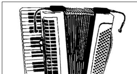
Fig. 6: Toma de acordeón con dos C 516 ML
