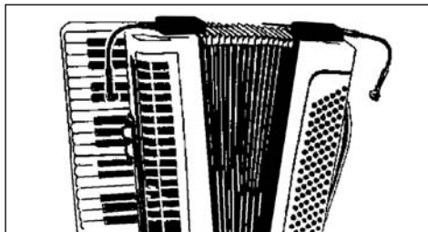
Fig. 6: Microfonar o acordeão com dois C 616 ML
