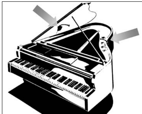
Abb. 9: Abnahme des Flügels mit zwei C 516 ML
