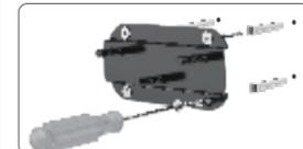
Paso 3: Taladre agujeros en las posiciones marcadas, inserte los anclajes en los agujeros y, a continuación, inserte los tornillos a través de la chapa de fijación a la pared e insértelos a los anclajes.
