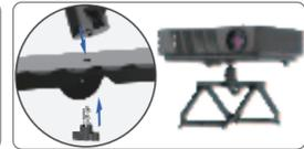
Schritt 2: Nehmen Sie den Kugelkopf heraus, richten Sie ihn mit dem Loch oben am Ständer aus, ziehen Sie ihn mit einer Z-förmigen Handschraube fest und befestigen Sie dann den Projektor am Kugelkopf.
