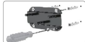
Schritt 3: Bohren Sie an den markierten Stellen Löcher, setzen Sie die Dübel in die Löcher ein, führen Sie dann die Schrauben durch das Wandbefestigungsblech und drehen Sie den Ständer in die Dübel.
