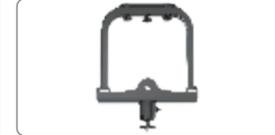
(1) Monte la cabeza esférica en la parte superior del soporte y apriétela al soporte con el tornillo manual en forma de Z.
