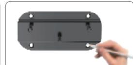
Schritt 2: Platzieren Sie das Wandbefestigungsblech an der Wand/Decke und zeichnen Sie 4 Markierungen, die die vier Lochpositionen ausrichten.
