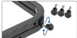
Schritt 1: Entfernen Sie die 4 runden Fußpuffer an der Unterseite des Ständers.
