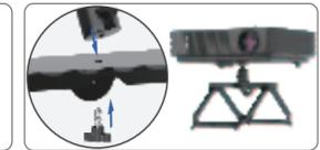
Étape 2 : Sortez la tête sphérique, alignez-la avec le trou en haut du support, serrez-la avec une vis à main en forme de Z, puis fixez simplement le projecteur à la tête sphérique.
