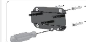
Étape 3 : Percez des trous aux emplacements marqués, insérez des chevilles dans les trous, puis insérez les vis à travers la tôle de fixation murale et faites pivoter le montage dans les chevilles.
