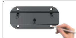
Paso 2: Coloque la chapa de fijación en la pared/techo y dibuje 4 marcas alineando las cuatro posiciones de los agujeros.
