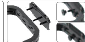
Étape 4 : Alinez les trous dans la partie inférieure du support avec les vis sur la tôle de fixation murale, puis insérez et serrez avec des écrous à main.
