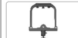
(1) Montez la tête sphérique sur le dessus du support et serrez-la sur le support avec la vis à main en forme de Z.
