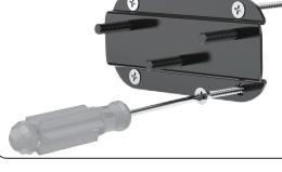
Étape 3: Percez des trous aux emplacements marqués, insérez des chevilles dans les trous, puis insérez les vis à travers la tôle de fixation murale et faites pivoter le montage dans les chevilles.
