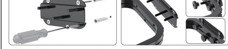
Schritt 3: Bohren Sie an den markierten Stellen Löcher, setzen Sie die Dübel in die Löcher ein, führen Sie dann die Schrauben durch das Wandbefestigungsblech und drehen Sie den Ständer in die Dübel.
