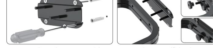
Paso 3: Taladre agujeros en las posiciones marcadas, inserte los anclajes en los agujeros y, a continuación, inserte los tornillos a través de la chapa de fijación a la pared y atornille el soporte a los anclajes.
