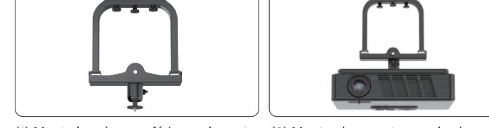
(1) Monte la cabeza esférica en la parte superior del soporte y apriétela con el tornillo manual en forma de Z.
