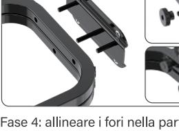
Fase 4: allineare i fori nella parte inferiore del supporto con le viti sulla lamiera di fissaggio a parete, quindi inserire e serrare con dadi a mano.
