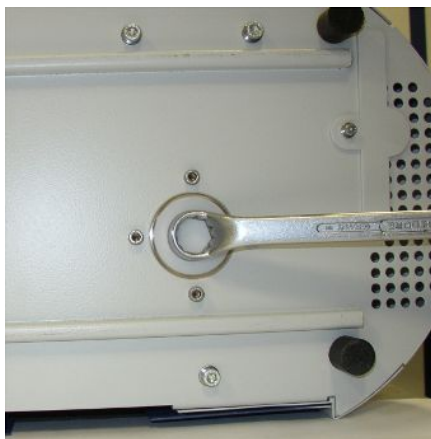
Obr. 48: Uzávěr zásobníku provozního prostředku
