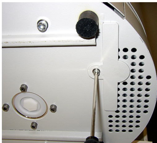
Obr. 47: Uvolnit kryt větráku
