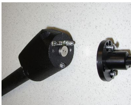
Obr. 53: Spékané filtry v držadle čichací sondy
