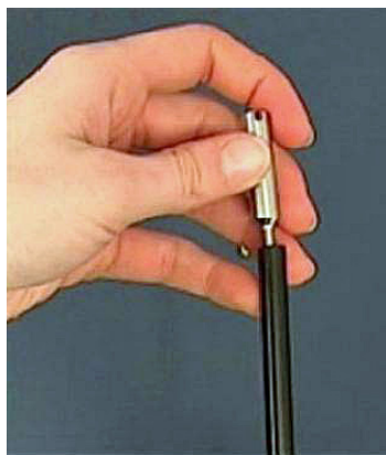
Obr. 7: Přišroubování násady proti nasání vody
