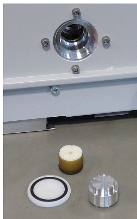
Obr. 49: Otevřená nádržka provozní kapaliny
