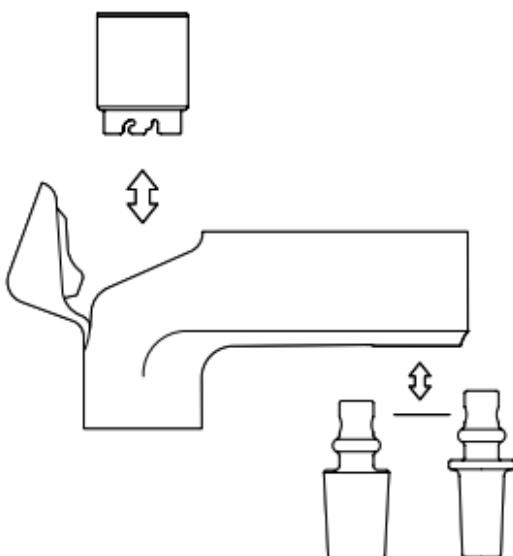
Para uma limpeza a fundo, retire a câmara 3D e o encaixe de vidro do adaptador de vidro.
