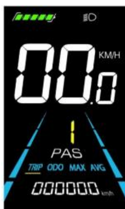
Figure 5-4 Écran d'allumage des lumières et de réglage du rétro-éclairage (luminosité)
