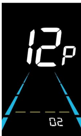
Figure 6-12 Écran de réglage de la force d'assistance au pédalage
