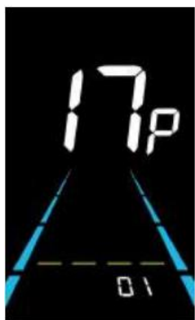
Figure 6-17 Écran de réglage du régulateur de vitesse du contrôleur
