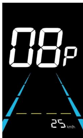
Figure 6-8 Écran de réglage de la limite de vitesse
