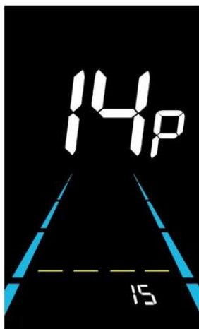
Figure 6-14 Écran de réglage de la limite de courant du contrôleur
