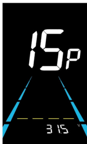
Figure 6-15 Écran de réglage de la valeur de sous tension de la batterie
