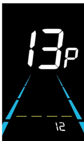
Figure 6-13 Écran de réglage du nombre d'aimants du capteur d'assistance au pédalage
