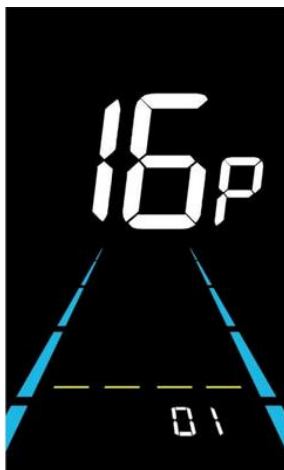
Figure 6-16 Écran de réinitialisation de l'ODO (compteur kilométrique total)
