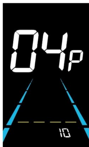
Figure 6-4 Écran du temps de mise hors tension automatique
