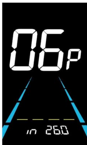
Figure 6-6 Écran de réglage du diamètre de la roue
