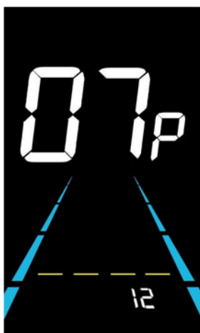
Figure 6-7 Écran de réglage du nombre d'aimants du capteur de vitesse
