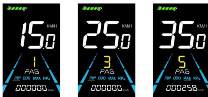
Figure 5-5 Écran d'affichage de niveau PAS Pour modification de la puissance de sortie du moteur
