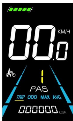
Figure 5-3 Aide à la mise en œuvre de l'écran d'affichage Amplification de la marche à une vitesse fixe de 6 km/h
