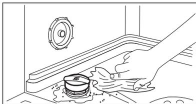
6. Tournez le bouchon dans le sens des aiguilles d'une montre pour le fermer.
