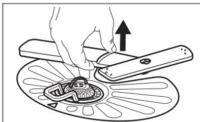
2. Lavez le bras d'aspersion sous l'eau courante. Utilisez un outil pointu comme un cure-dent pour extraire toutes les particules de saleté incrustées dans les orifices. Faites couler de l'eau dans les orifices pour éliminer les particules de saleté se trouvant à l'intérieur.
