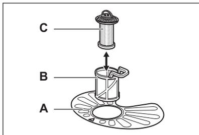
1. Tournez le filtre (B) dans le sens inverse des aiguilles d'une montre et sortez-le.
