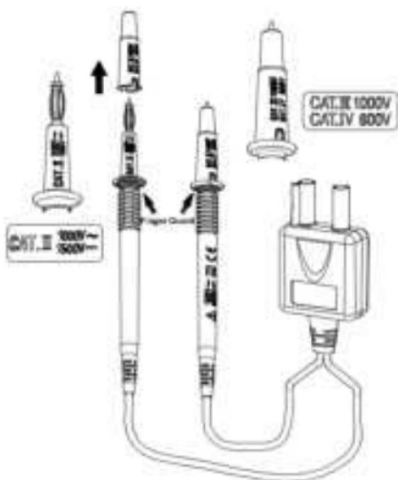
Pour les environnements CAT III ou CAT IV, utilisez les cordons de test avec le capuchon de protection de l'extrémité de la sonde fixé fermement. Sans le bouchon de protection de la pointe de la sonde, les fils de test peuvent être utilisés dans un environnement CAT III UNIQUEMENT.
