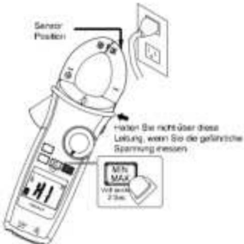
Drücken Sie die MIN/MAX-Taste l盲nger als 2 Sekunden, um den Volt-Suchmodus aufzurufen zu verlassen. Drücken Sie die MIN/MAX-Taste, um zwischen hoher und niedriger Empfindlichkeit umzuschalten.
