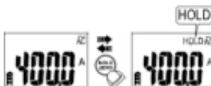
Le compteur émet un bip continu et l'affichage clignote si le signal mesuré est supérieur de 50 points à la valeur affichée. (Dépendant, il ne peut pas détecter à travers la tension / courant alternatif et continu).
