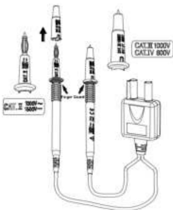
Para entornos CAT III o CAT IV, utilice los puntos de prueba con la tapa protectora de la sonda asegurada. Sin la tapa protectora de la sonda, las puntas de prueba se pueden utilizar únicamente en entornos CAT III.
