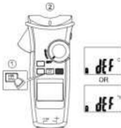
Schalten Sie das Messgerät ein, nachdem Sie die MIN/MAX-Taste gedrückt gehalten haben.
