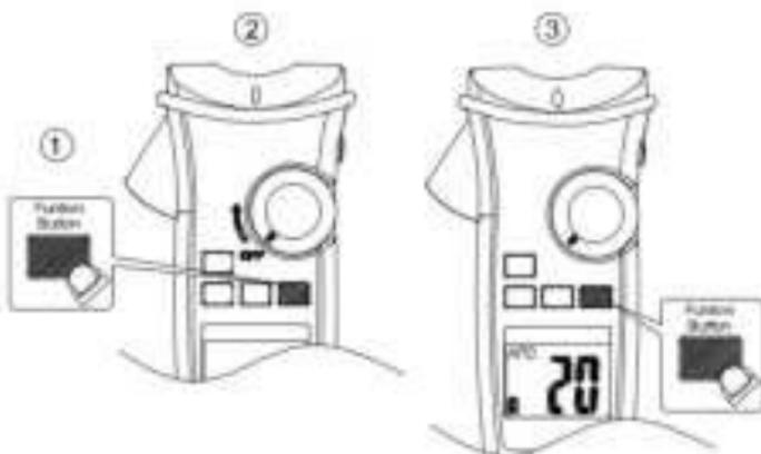
Drücken Sie die Funktionstaste und schließen Sie das Messgerät ein. Drücken Sie dann die Funktionstaste, um die Uhrzeit auszuwählen. Die Zeit kann 5 Minuten, 10 Minuten, 20 Minuten und deaktiviert (AUS) sein.
