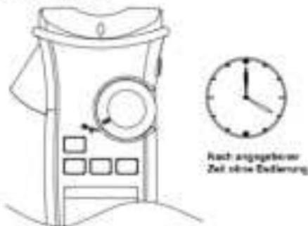
Wecken Sie das Messgerät auf, indem Sie den Schalter wählen oder eine beliebige Taste drücken.
