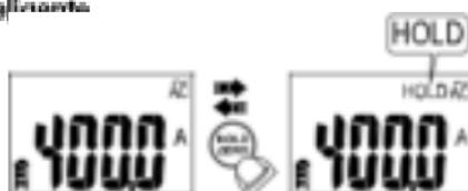
El medidor pitágora continuamente y la pantalla parpadeará si la señal medida es mayor de 50 unidades que la leída. (Sin embargo, no puede detectar a través de la tensión contenido CA y CC).
