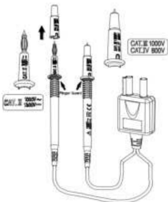
Für CAT III- oder CAT IV-Umgebungen verwenden Sie die Messleitungen mit fest angebrachter Schutzkappe der Sondenspitze. Ohne die Schutzkappe für die Sondenspitze können die Messleitungen NUR in CAT II-Umgebung verwendet werden.
