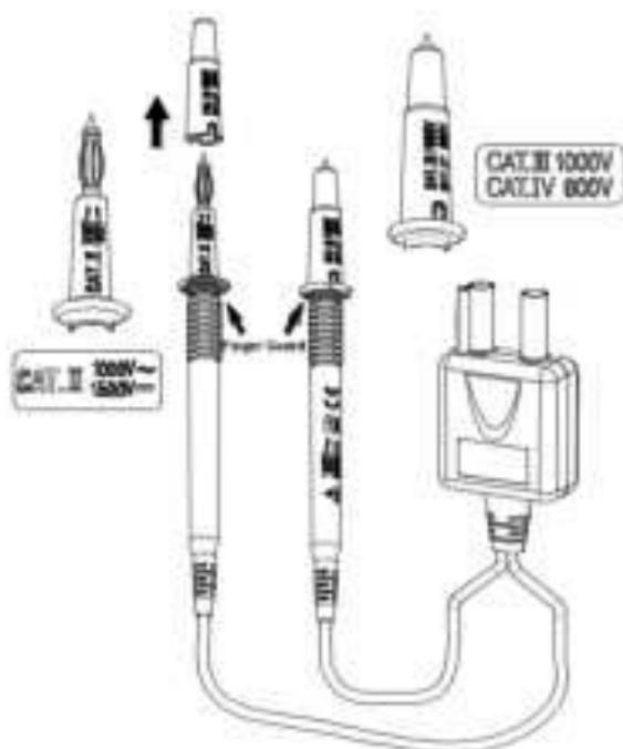
Per ambienti CAT III o CAT IV, utilizzare i conduttori di prova con il coperchio di protezione della punta della sonda fissato saldamente. Senza il coperchio di protezione della punta della sonda, i conduttori di prova possono essere utilizzati SOLO in ambiente CAT II.
