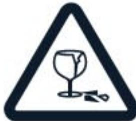
Das Gerät und/oder sein Display bestehen aus Glas. Dieses Glas kann brechen, wenn das Gerät auf eine harte Oberfläche fällt oder einem heftigen Schlag ausgesetzt wird. Wenn das Glas bricht, berühren Sie die Glassplitter nicht mit den Händen und versuchen Sie nicht, die Glassplitter vom Gerät zu entfernen. Verwenden Sie das Gerät erst wieder, nachdem das Glas durch autorisiertes Kundendienstpersonal ersetzt wurde.
