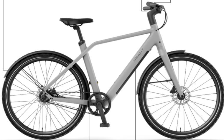
Moteur dans le moyeu arrière
