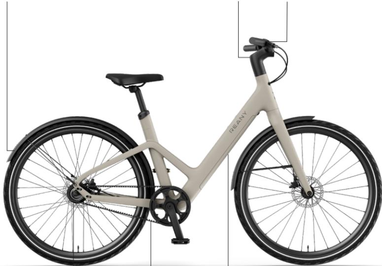
Moteur dans le moyeu arrière
