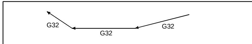
Fig. 3.4 (a) Roscado continuo (ejemplo de G32 en el sistema A de código G)
