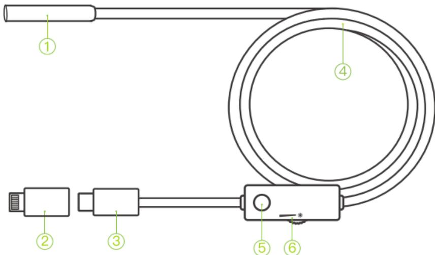
1. Kamera      2. Lightning-Anschluss      3. Typ-C-Anschluss
