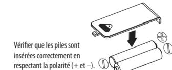
Vérifier que les piles sont insérées correctement en respectant la polarité (+ et -).
