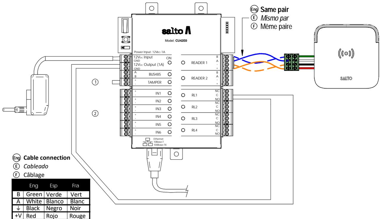
**Eng** Installation example with RJ45    **E** Ejemplo de instalación RJ45
