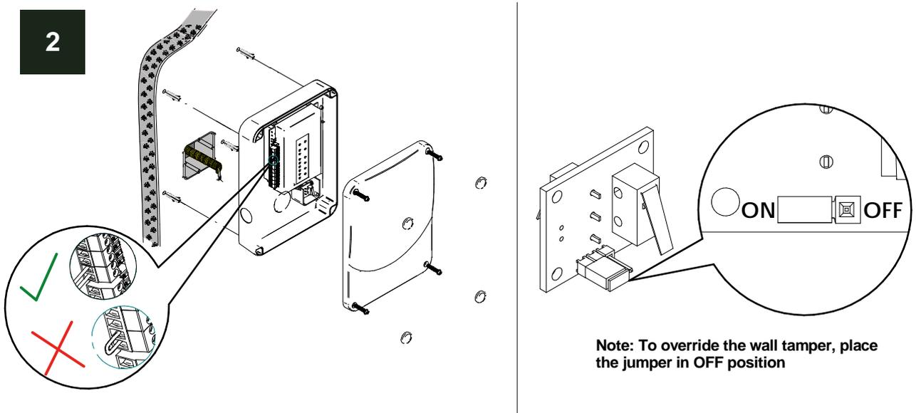
**Hinweis:** Befolgen Sie das gleiche Anschlussprinzip des Sabotageeingangs der CU, wenn Sie ein elektrisches Gerät eines Drittanbieters verwenden, das mit einer Sabotageüberwachung ausgestattet ist.
