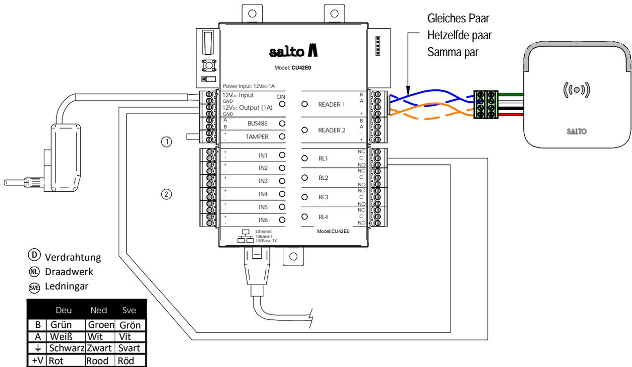
**D** Installationsbeispiel RJ45 **NL** Installatie voorbeeld RJ45 **SVE** Installationsexempel RJ45
