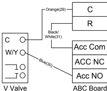
**REMARQUE :** Le SW2-4 doit être en position de marche (ON) et le SW2-5 doit être en position d'arrêt (OFF) lorsque la valve d'eau à ouverture lente (V100FPT) est utilisée.
