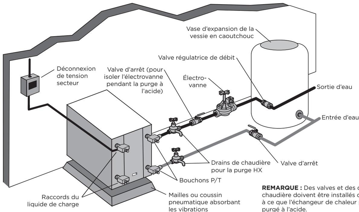
**REMARQUE : Des valves et des drains de chaudière doivent être installés de manière à ce que l'échangeur de chaleur puisse être purgé à l'acide.**
