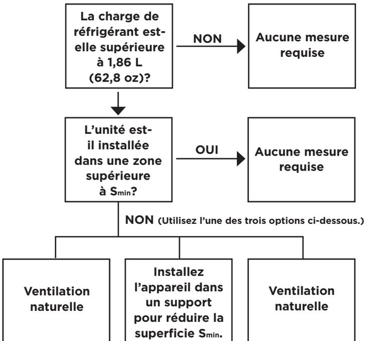
Utilisez le Tableau 1 pour déterminer la surface minimale de plancher,  $S_{min}$ . Le matériel doit être installé avec une surface minimale de plancher égale ou supérieure à la surface indiquée dans le tableau en fonction de la charge totale de réfrigérant de ce système. Si la zone n'est pas assez grande, vous devez passer à l'étape suivante pour les exigences d'installation supplémentaires.
