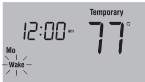
**REMARQUE:** Pour afficher la température du point de réglage, appuyer une fois sur le bouton **haut** ou **bas**. Pour modifier le point de réglage, appuyer une fois de plus sur l'un ou l'autre bouton.
