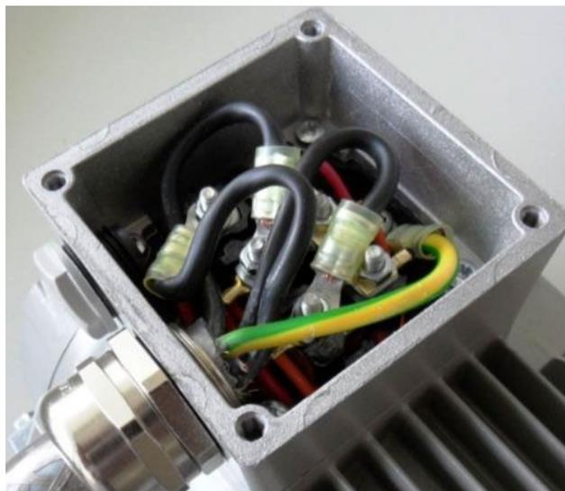
Fig. 25: Cablaggio nella scatola morsettiera del motore
