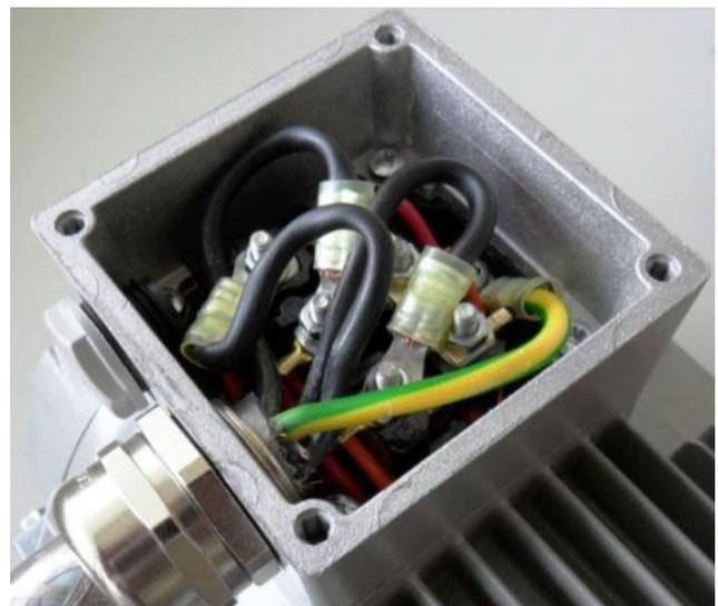
Fig. 32: Cablaggio nella scatola morsettiera del motore
