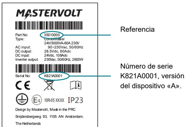
El adhesivo de identificación incluye información importante necesaria para el servicio técnico y el mantenimiento. El adhesivo de identificación se encuentra en el lado derecho del CombiMaster.
