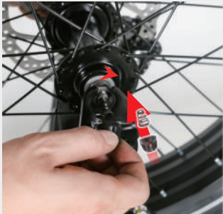
Apriete el desmontaje rápido en la dirección
