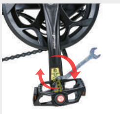
iehen Sie das rechte Pedal mit der Markierung "R" im Uhrzeigersinn an.
