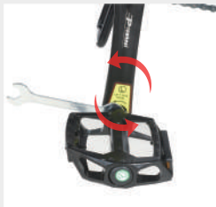
Serrer la pédale gauche marquée "L" dans le sens inverse des aiguilles d'une montre.
