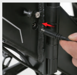
Método 1: Cargue la bicicleta eléctrica directamente en la dirección indicada por la flecha.
