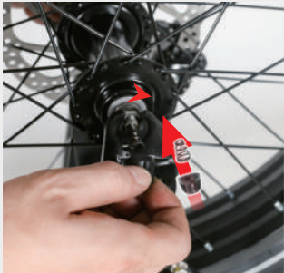
Serrer le démontage rapide dans le sens des aiguilles d'une montre.
