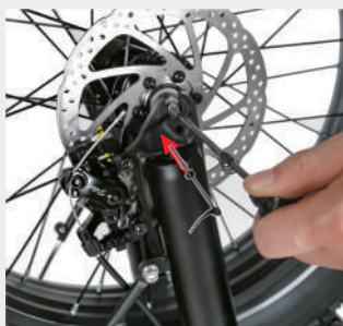
Setzen Sie die Schnellspannklemme in den Schlitz der Vorderradklemme
