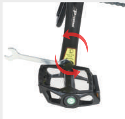
Avvitare il pedale sinistro contrassegnato con "L" in senso antiorario.
