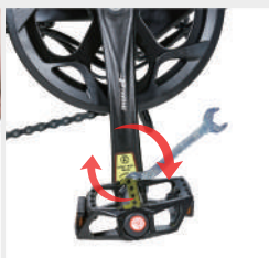
Serrer la pédale droite marquée "R" dans le sens des aiguilles d'une montre.
