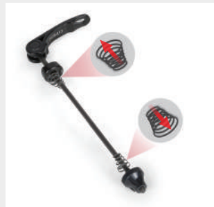
Saque la abrazadera de cierre rápido, prestando atención a la dirección del muelle.
