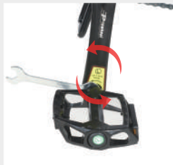
Das linke Pedal mit der Markierung "L" gegen den Uhrzeigersinn anziehen.
