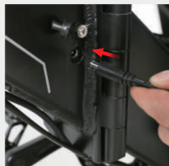
Metodo 1: caricare la bicicletta elettrica direttamente nella direzione indicata dalla freccia
