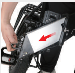
Retire la batería en la dirección indicada.
