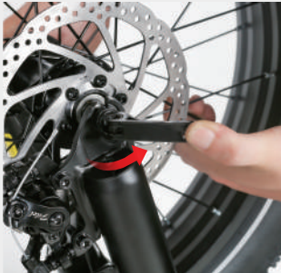
Premere saldamente il morsetto a sgancio rapido per garantire una salda tenuta.
