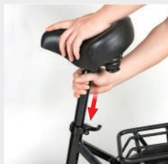
Inserte el tubo de asiento en la dirección
