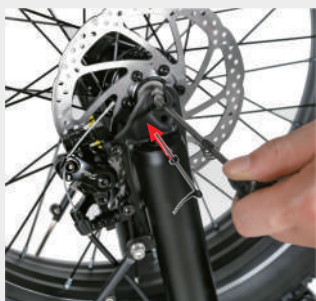
Coloque la abrazadera de liberación rápida en la ranura de la abrazadera de la rueda delantera.
