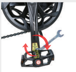
Avvitare il pedale destro contrassegnato da "R" in senso orario.
