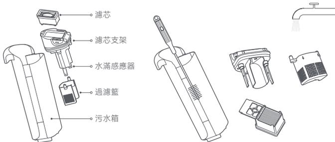
4. 原路裝回濾芯、過濾籃、污水箱的濾芯支架，然後將污水箱裝回洗地機，聽見「喀噠」一聲，即表示安裝到位。
