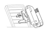
2.将产品充电线插入支架底部插口,产品自动回复到打开状态,将手机放入, 支架红外感应到手机然后夹臂合并,锁紧手机;并开始给手机充电。
