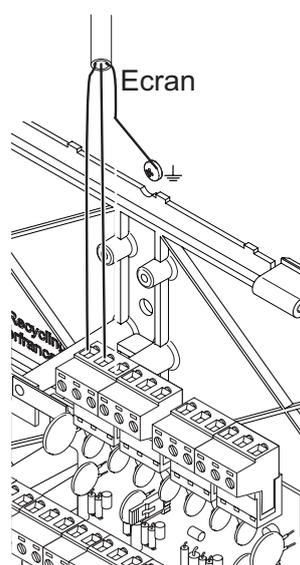
Dans ce cas, les deux fils de liaison CMSI B/déclencheurs sont raccordés aux connecteurs + et - (aller/retour) de la carte de boucle. L'écran est raccordé à l'enveloppe de la centrale par l'intermédiaire d'une vis de liaison (non fournie). S'il s'agit d'une ligne rebouclée, les deux extrémités de l'écran devront être reliées à l'enveloppe de la centrale.
