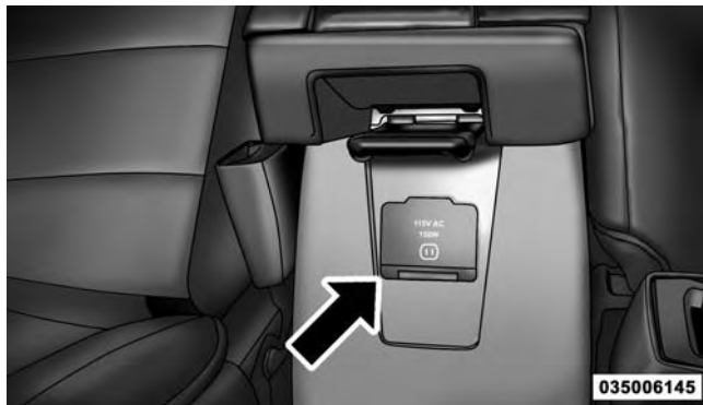
115 Volt Power Outlet
