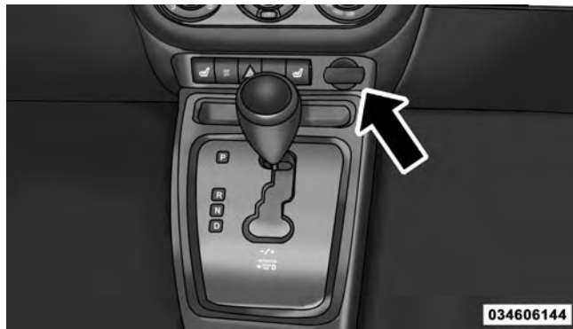
12 Volt Power Outlet
