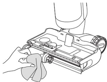
2. Reinigen Sie die Walzenbürste mit der mitgelieferten Reinigungsbürste. Spülen Sie die Walzenbürste und die Abdeckung mit sauberem Wasser ab und trocknen Sie diese vollständig.
