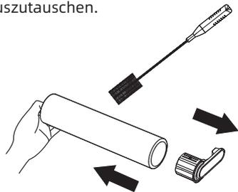
5. Wischen Sie den Saugeinlass mit einem trockenen Tuch oder einem feuchten Lappen ab. Spülen Sie die Bürsten-Aufsätze nicht mit Wasser ab.
