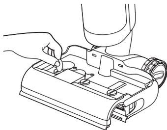
6. Setzen Sie die Walzenbürste wieder ein, bis Sie ein Klickgeräusch hören. Verriegeln Sie die Walzenbürstenabdeckung wieder.
