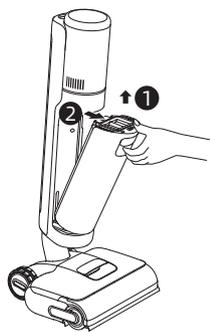
2. Nehmen Sie den Filter aus der Abdeckung des Schmutzwasserbehälters. Ziehen Sie die Abdeckung des Schmutzwasserbehälters hoch und schütten Sie das Schmutzwasser aus.
