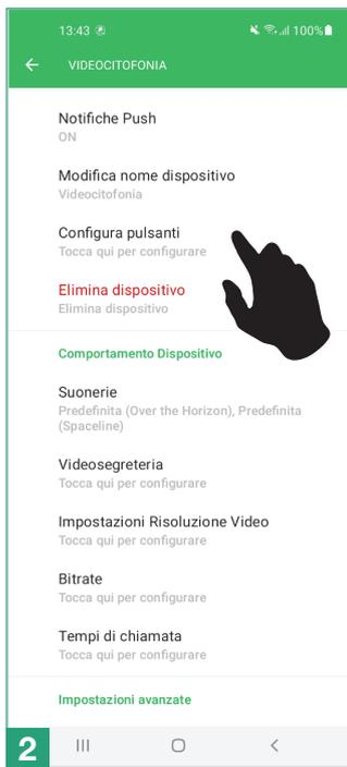
Selezionare il pulsante da configurare. È possibile configurare solo i pulsanti abilitati con la funzione "Link x" sul Mini Handsfree Wi-Fi
