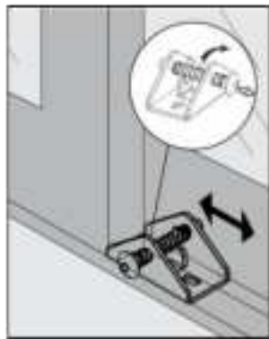
Spärrmontering i nedre spår
