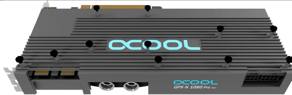
Schrauben Sie den Kühler zusammen. Die Schrauben dabei kreuzweise mit je einer Umdrehung anziehen. Ziehen Sie nun auch noch einmal die Schrauben aus Schritt 5, welche die Platinen mit dem Kühler verbinden, nach. Beachten Sie dabei die Hinweise.
