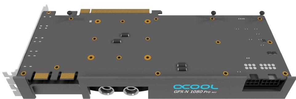
Schrauben Sie die Schrauben mit den Unterlegscheibe wie im Bild zu sehen ein. Ziehen Sie die Schraube aber noch nicht fest an.
