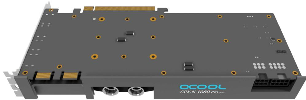
Montieren Sie nun den zusammengebauten Kühler auf die Grafikkarte. Falls eine Schutzfolie auf dem Kühlerboden vorhanden ist, entfernen Sie bitte jetzt die Schutzfolie. Reinigen Sie die Kontaktflächen auf der Bodenseite des Kühlers mit Spiritus oder ähnlichen Mitteln. Die Fläche muss frei von Verunreinigungen sein.
